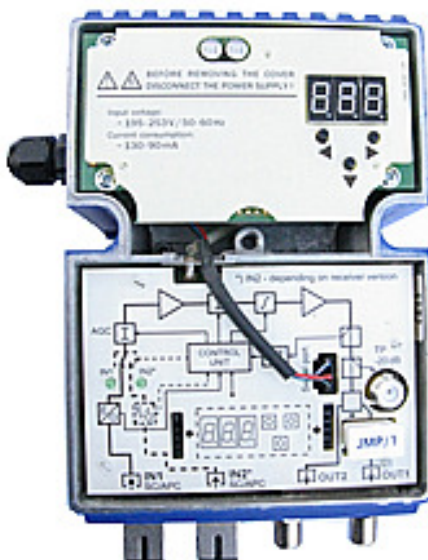
Rys. 5.2. Wnętrze odbiornika optycznego MOB-729 z zamontowanym fabrycznie modułem monitoringu zdalnego M-729.
