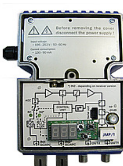
Rys. 5.1. Wnętrze odbiornika optycznego MOB-729 z modulem monitoringu lokalnego C-729.
